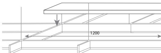
Поместить светильник на Т-образную конструкцию потолка
