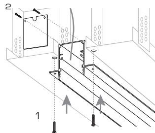
3 Закрепите корпус светильника на каркасе саморезами и прикрутите торцевую заглушку
