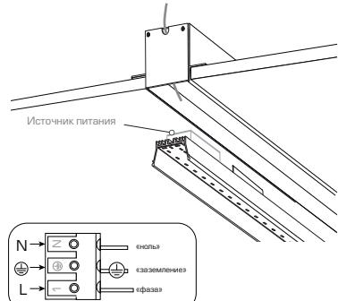
6 Подключите кабель питания к клемной колодке на монтажной пластине в соответствии с маркировкой
