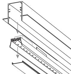
1 Снимите из пазов светильника рассеиватель и монтажную пластину
