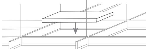
2. Поместить светильник на Т-образную конструкцию потолка
