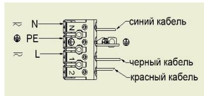
3. Подключите питающие провода к клеммной колодке, соблюдая условие: “L” – фаза, “N” – ноль, – заземление (см. рис.).
